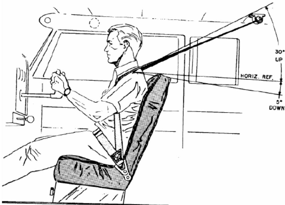
**FIGURE 9-8. THE 4-POINT INDEPENDENT HARNESSES POSITIONING**
