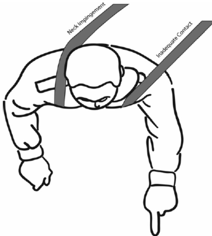
**FIGURE 9-6. UNDESIRABLE VERTICAL HARNESS POSITIONING**
