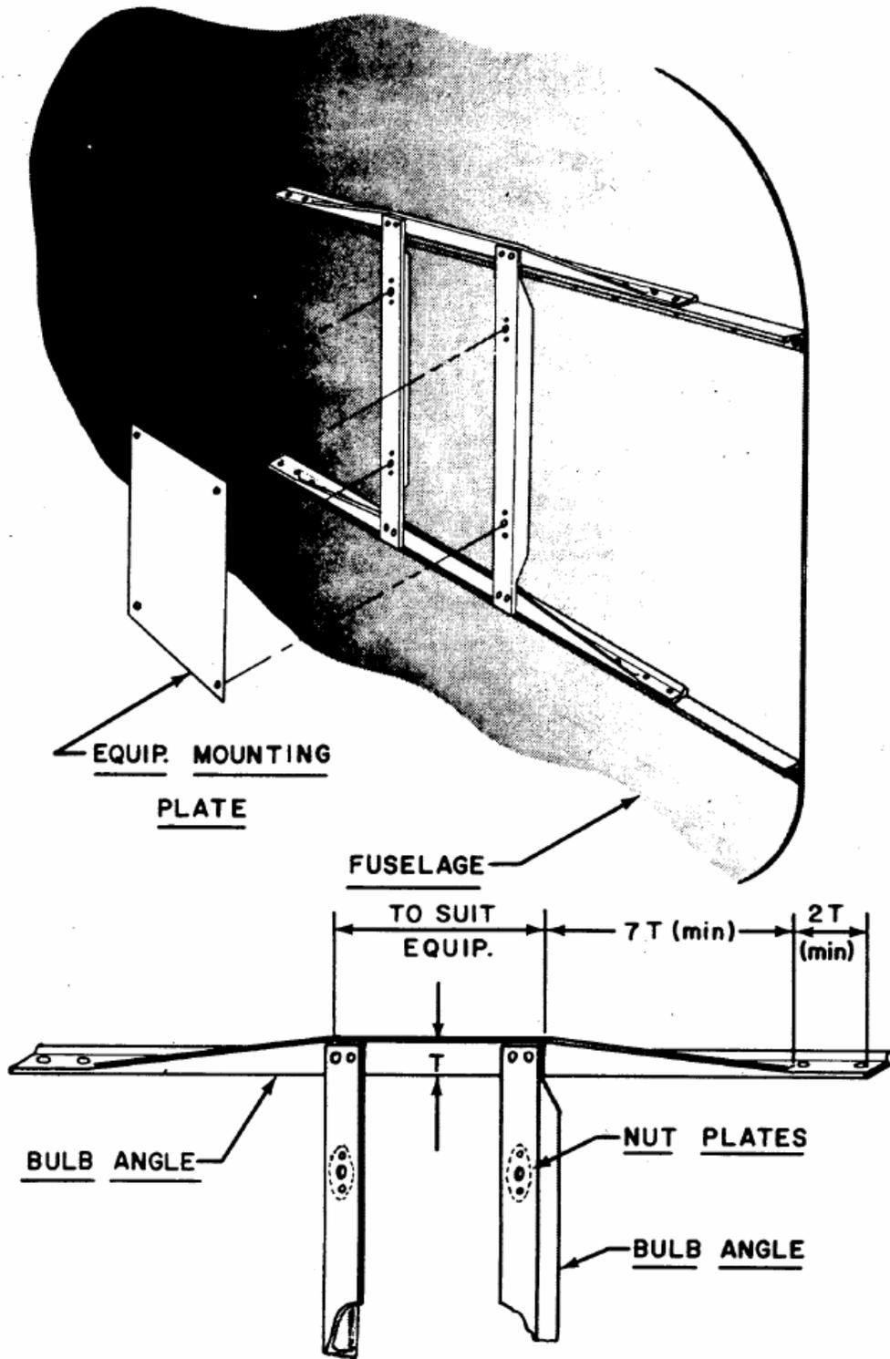
**FIGURE 2-9. TYPICAL SHELF INSTALLATION**
