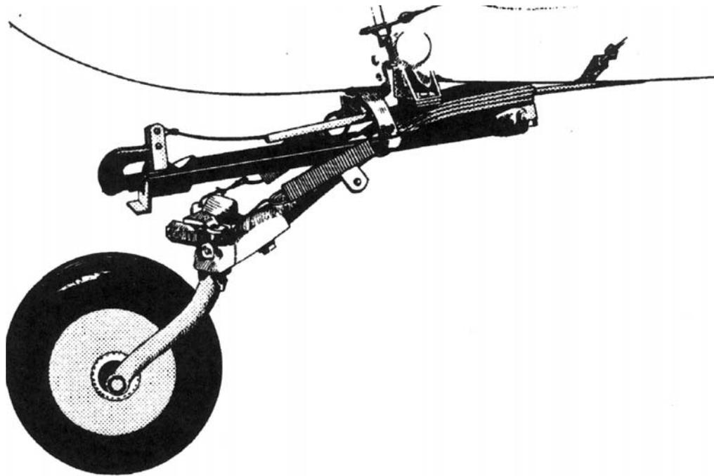
**FIGURE 8-6. CONVENTIONAL GEAR AIRCRAFT-SHOCK STRUT TYPE TAILWHEEL**
