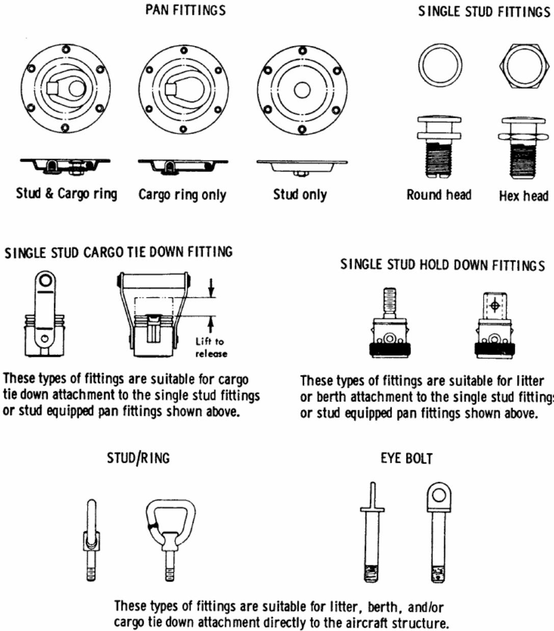
**FIGURE 12-3. TYPICAL ATTACHMENT OF FITTINGS TO HONEYCOMB STRUCTURES**
