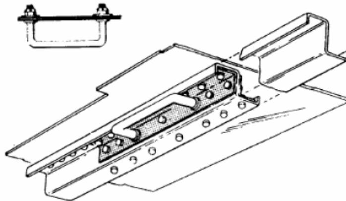
**FIGURE 9-18. TYPICAL LOCALIZED STRINGER SECTION REINFORCEMENT INSTALLATION**
