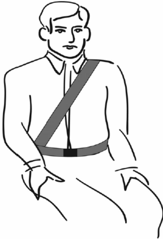
**FIGURE 9-3. SIDE MOUNTED SINGLE DIAGONAL TYPE HARNESS**
